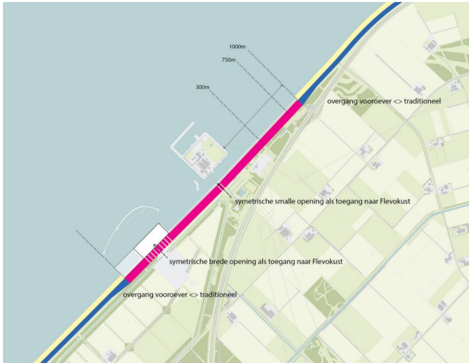
Figuur 3-5: variant B (blauw huidige dijk, geel vooroever en rood traditionele dijkversterking)
