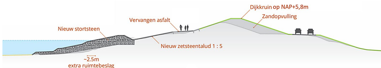
Figuur 4-33: Dwarsdoorsnede van het referentieontwerp op het traject Meerdijk-midden
