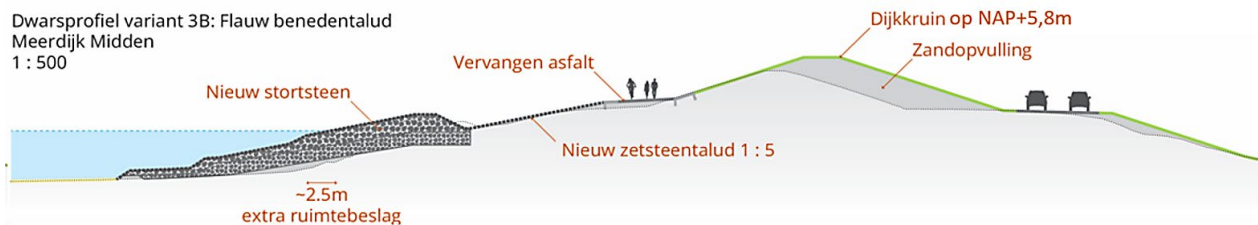
Figuur 4-4: Ontwerpprofiel Traditionele dijkversterking Meerdijk-midden (inclusief effect kruinverlaging 20cm van proef erosiebestendige overgangen)
